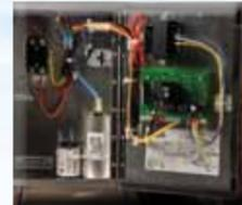
**Contrôle de température électronique**
