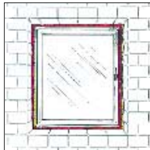
Étanchéité de l'embrasure de fenêtre par un cordon courant tout autour.
