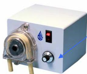
Une molette de réglage permet de faire varier le débit de la pompe. Pour un bassin jusqu'à 150 m<sup>3</sup>, la molette sera réglée sur ❶, ce qui signifie que la pompe fonctionnera 10% du temps donné par le régulateur. On évite ainsi de trop fortes variations de pH liées à la taille du bassin, car il faut un certain temps entre l'injection d'acide et la constatation par l'appareil de la modification du pH.
