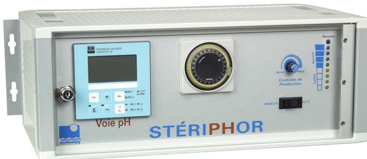
**TENSION** Cet indicateur est allumé lorsque la cellule d'électrolyse est sous tension, c'est-à-dire avec l'interrupteur en position "MANUEL" ou s'il est en position "AUTO" pendant les plages programmées. Cet indicateur ne concerne que la partie "ÉLECTROLYSE" de l'appareil.
