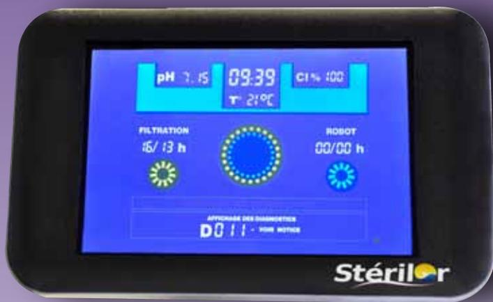
DUO Insight est la dernière génération des systèmes de traitement de l'eau. Il intègre les fonctions d'électrolyseur de sel, d'analyse et de régulation du pH, et son boîtier autonome positionné à l'intérieur de la maison permet de visualiser tous les paramètres sans avoir à se déplacer dans le local technique. L'électrolyseur DUO effectue toutes les réceptions d'informations et les transmet au boîtier déporté Insight.
