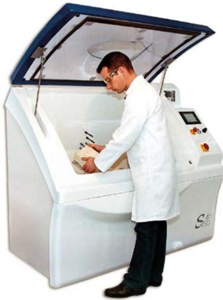
Notre laboratoire le LRDTM, est mis à votre disposition pour contrôler la cohésion, la dureté, la glissance et la porosité de vos matériaux. Nos enceintes climatiques reproduisent le vieillissement accéléré avant et après minéralisation des matériaux.
